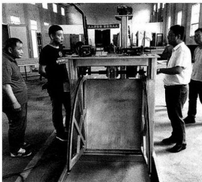
■活页式活动堰型测控一体闸检测
