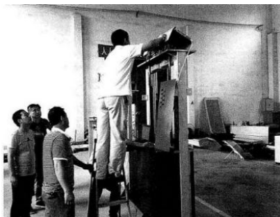
■底升式活动堰型测控一体闸检测
