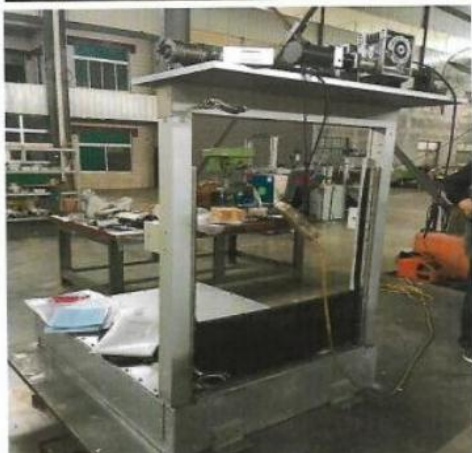
■ 卷帘式活动堰型测控一体闸检测
