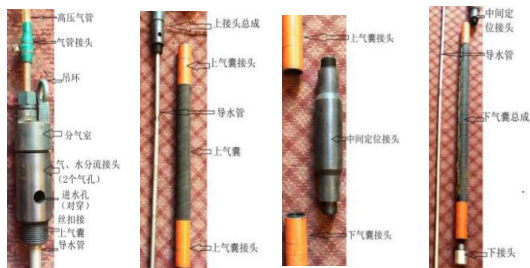
■ 轻便式气囊隔离随钻压水试验器结构组成
