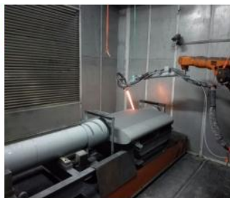
■小浪底水电站水轮机导叶磨蚀严重经行修复并抗磨蚀涂层防护
