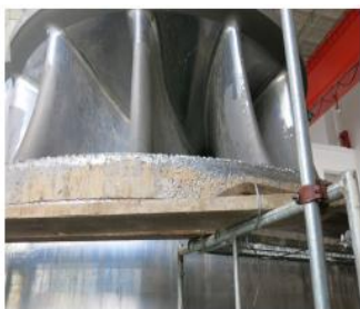
■小浪底水电站水轮机导叶磨蚀严重经行修复并抗磨蚀涂层防护
