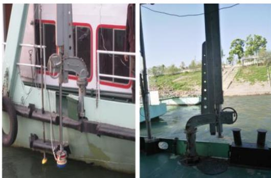
■ 水文测验设备的联控装置实物图
