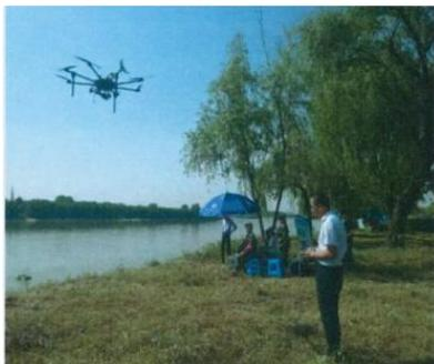
■ 无人机测流系统对泰州引江河开水文应急监测
